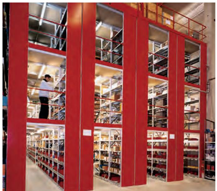
4-geschossige Fachbodenregalanlage mit Lagerbühne, Schutzgeländer, Klapptor und Vollblechstirnwänden.
