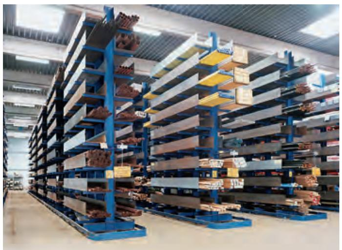
*Kragarm-Doppelregale mit Führungsschienen für die Staplerbedienung.
