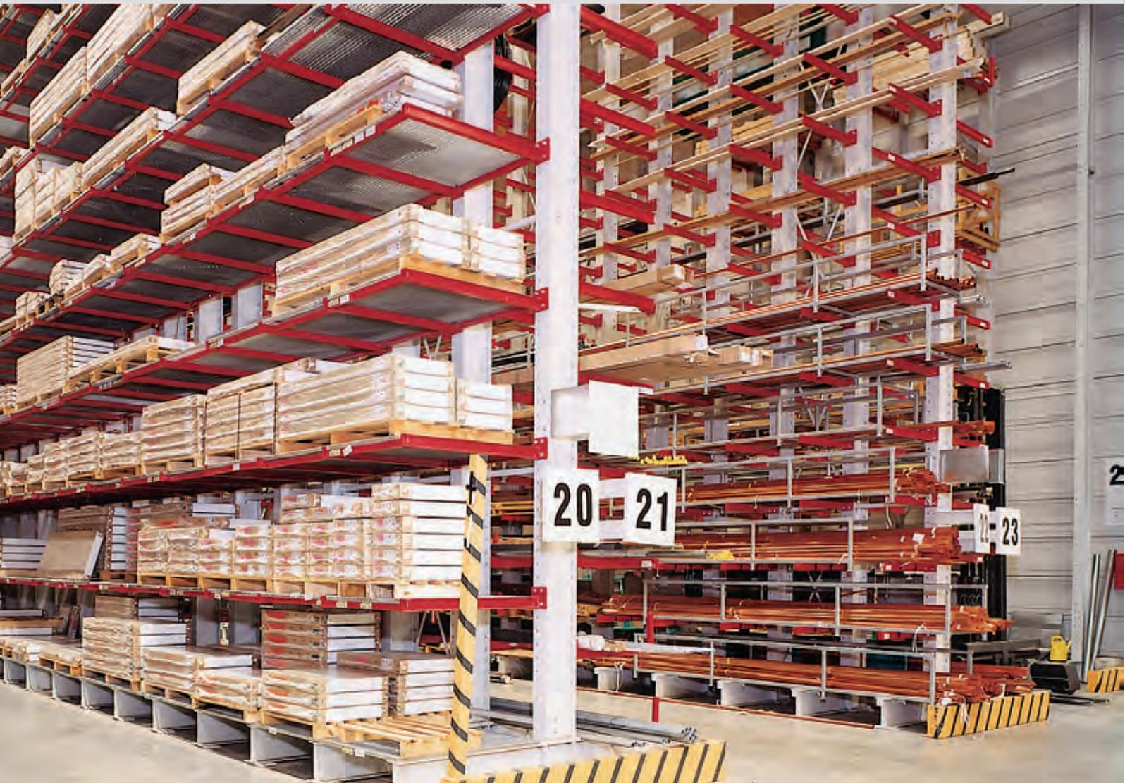
*Kragarm-Doppelregale mit Gitterrostauflagen, Abfallsicherungen schützen das Lagergut gegen Herausfallen.
